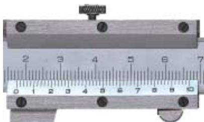
C'est le vernier qui fait la précision du pied à coulisse. Il possède 50 graduations correspondant à une longueur de 49 mm, d'où la longueur d'une graduation :  $1\text{mm} - 0,08 = 0,98$
