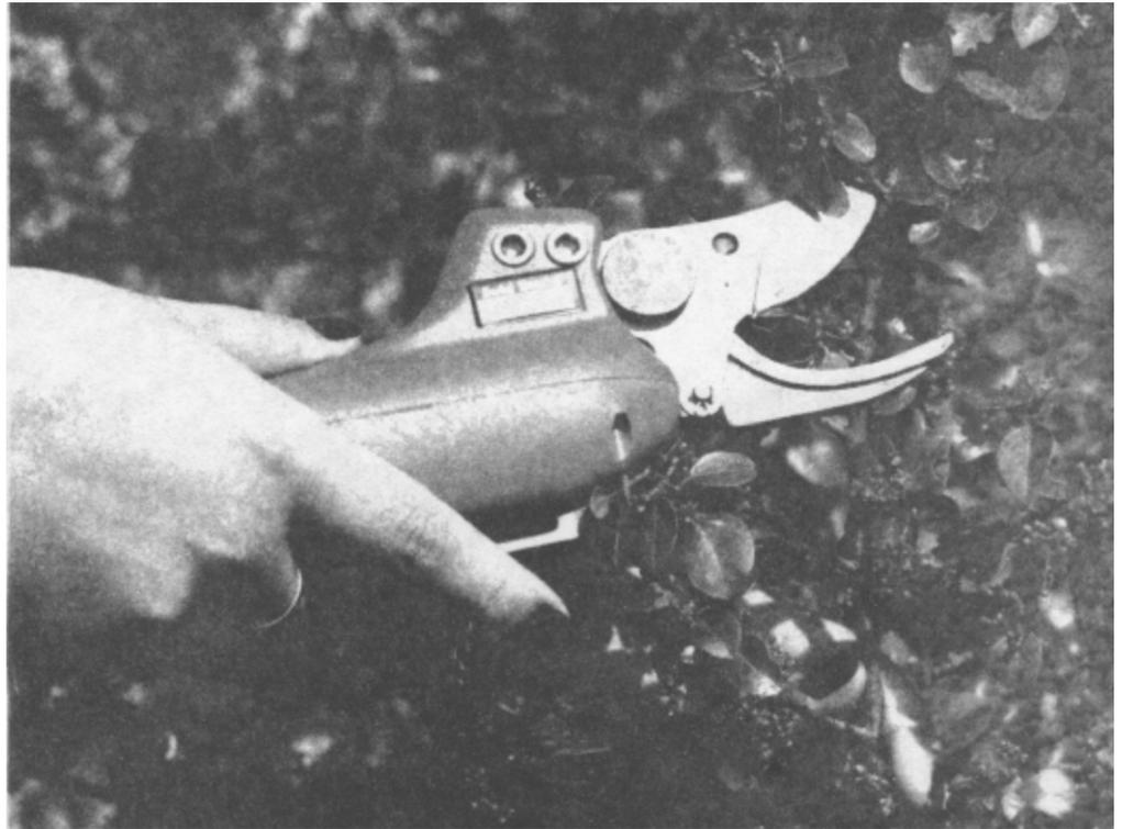
La société PELLENC commercialise un sécateur électrique à commande électronique. Ce système se compose d'une valise contenant l'essentiel de la partie de commande (électronique). L'utilisateur porte cette mallette attachée à la ceinture. Un câble permet l'alimentation et le transfert d'informations avec le sécateur.
