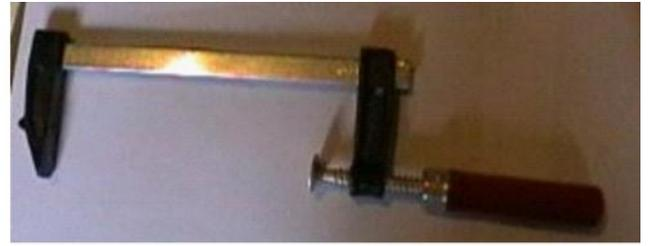
Cet outillage peut servir pour maintenir en pression afin de coller, riveter, souder... Doté d'embout plastique, le serre joint peut être utilisé sur des matière fragile, par exemple le bois, sans risquer de le marquer.
