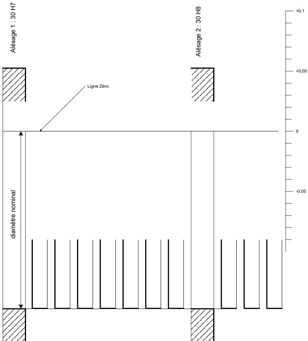
1.2. En utilisant le progiciel **cotation** ou vos **tableaux**, **complétez** le document ci-dessous conformément au schéma donné ci contre pour les ajustements suivants en les classant par ordre décroissant du jeu maxi au serrage maxi.
