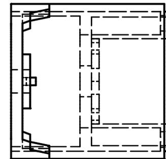
Réalisez une vue de dessus en coupe A-A passant par la symétrie de la pièce, puis une vue de droite en coupe B-B permettant de visualiser l'intérieur du cylindre de diamètre 40.
