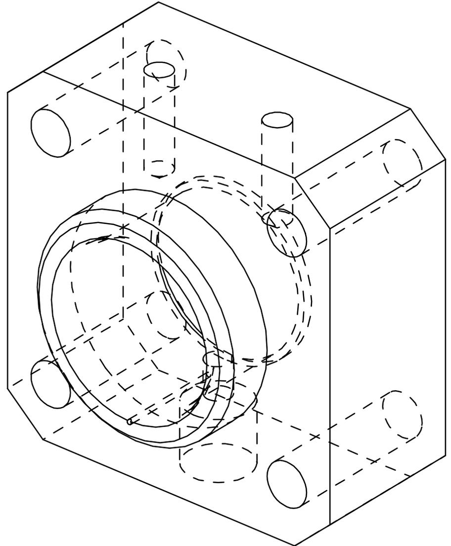
*A partir de ces perspectives réalisez un dessin à main levée de ce flasque arrière de vérin en vue de face et en vue de gauche en coupe à plans parallèles permettant de voir les différents perçages.
