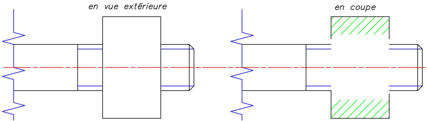
1.3.4. L'axe 1 se termine par un filetage M24 jusqu'à l'épaulement.
