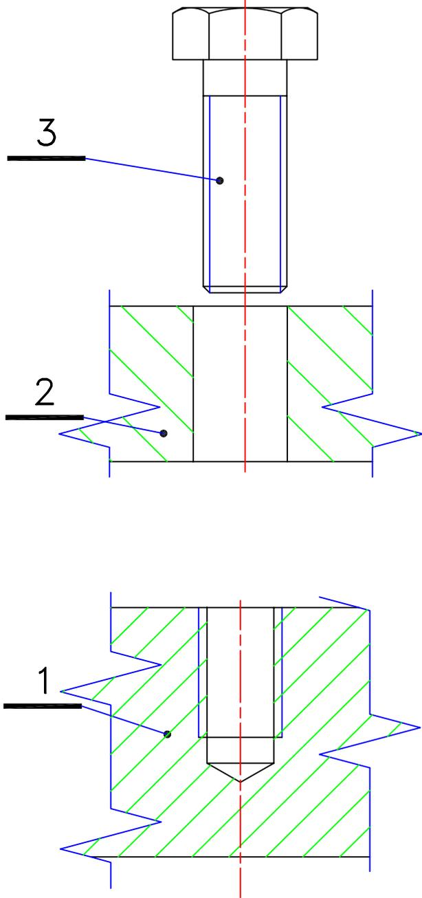
2. Réaliser le montage des 3 pièces ci-contre en complétant l'esquisse ci-dessous.
