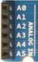
**2.2. Les 6 entrées analogiques** permettent de convertir une **tension analogique  $V_e$  de 0 à 5 V** en une **valeur numérique  $N$  (en décimale)** d'une résolution de **10 bits (1024 niveaux)**.
