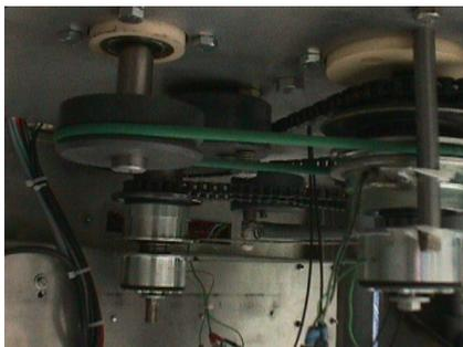
Un moteur électrique a une fréquence de rotation  $n = 1500\text{tr.min}^{-1}$ . Le mouvement de la poulie fixée sur l'arbre de sortie du moteur est une rotation.
