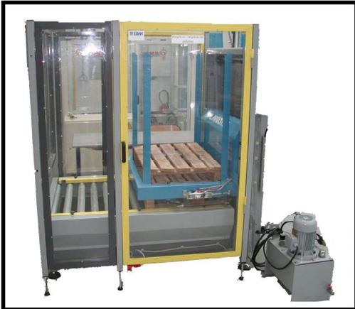
L'empileur dépileur est une machine qui permet en mode empileur d'acheminer les palettes une à une et de les stocker en les empilant dans le magasin.
