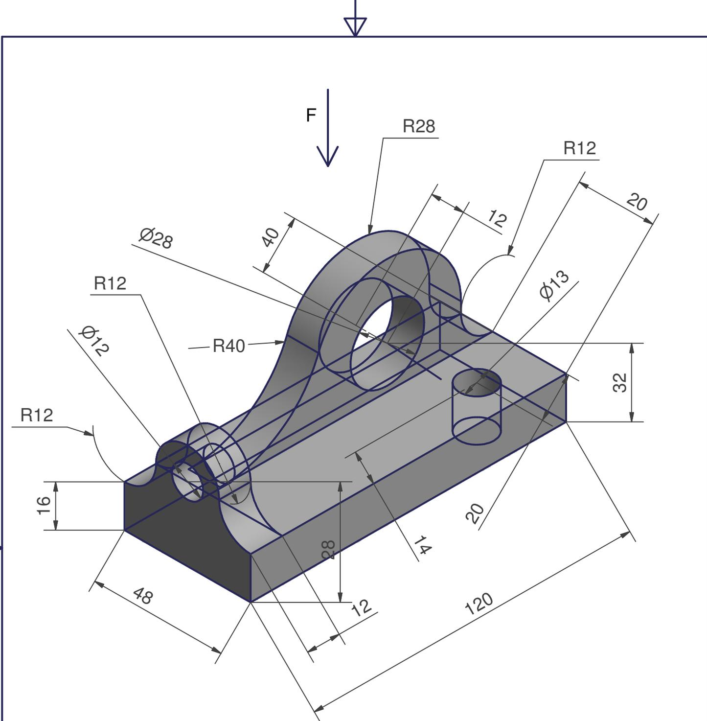
On donne la perspective isométrique d'un support de tringle.
