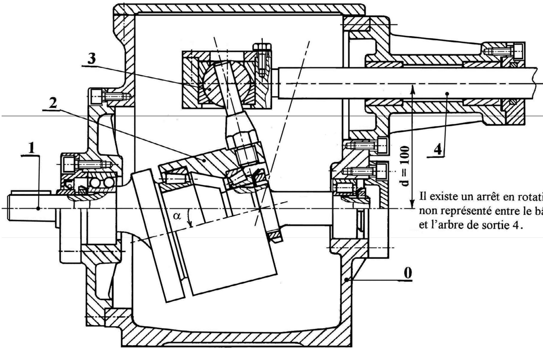
Il existe un arrêt en rotation non représenté entre le bâti 0 et l'arbre de sortie 4.
