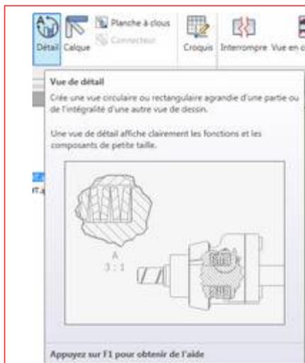
*Les vues de détail permettent d'obtenir des formes circulaires et rectangulaires du profil de détails. Les vues en question proposent différents types de lignes de coupe. Les trois objets d'annotation (le délimiteur, la limite et la ligne de raccordement) forment un même objet d'annotation.*
