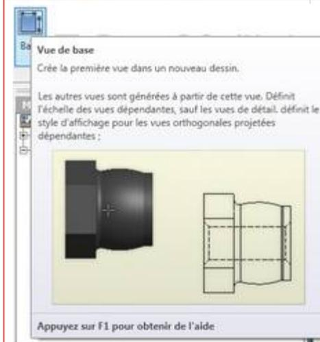
Dans le groupe de fonctions *Créer* de l'onglet *Placer les vues*, servez-vous des commandes pour placer des vues indépendantes dans des projections uniques à vues multiples ou isométriques ou pour placer une vue qui capture l'orientation actuelle du modèle.
