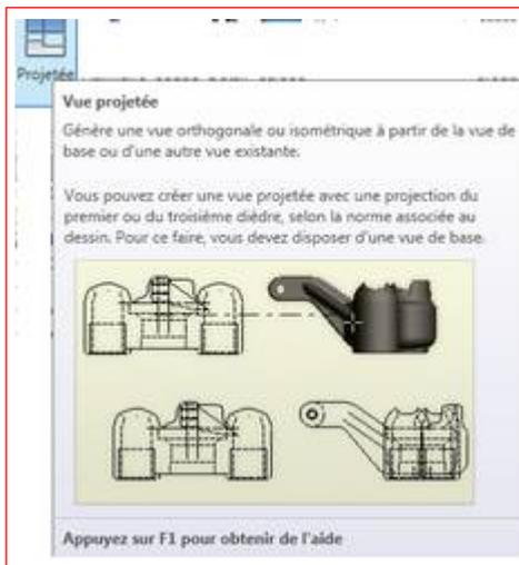
Les vues projetées constituent généralement le premier type de vue créé à partir d'une vue de base. La commande *Vue projetée* crée des vues orthogonales et isométriques à partir d'une vue de base. Une seule activation de la commande vous permet de créer plusieurs vues.
